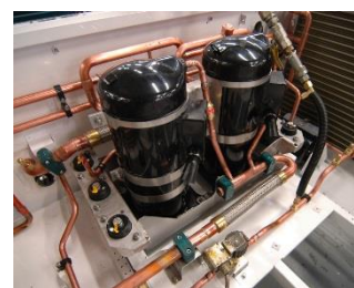
6.3.7. ábra. Párhuzamosan kötött kompresszorok Forrás: Thermo King LFR 8T BUD oktatási anyag
