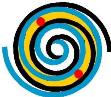
3.1.24. ábra. A spirálkompresszor álló- (fekete) és forgórésze (kék). Pirossal jelölve a befecskendezés helye.
