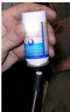
4.6.1. ábra. Szivárgáskereső vizsgálata próbalyukkal
