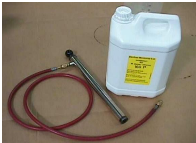
5.3.3. ábra. A pumpa és a tömlő átöblítése
